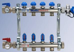
Collecteurs en acier inoxydable avec vannes d'égalisation de circuits et débitmètres
